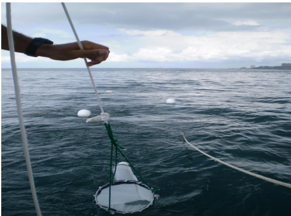
Figura 3: Rede cônica empregada para arrastos horizontais de subsuperfície.
