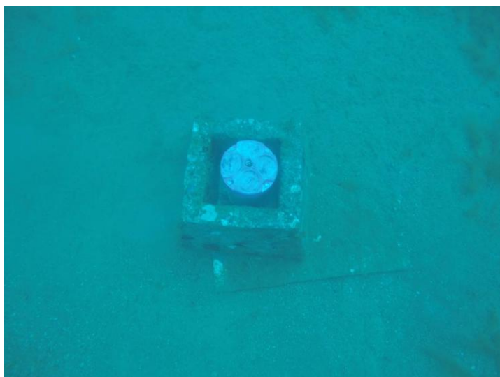
Figura 4 – ADCP fundeado à sua estrutura de concreto.
