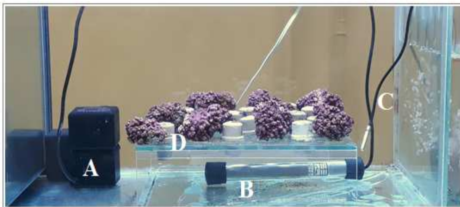
Figura 3.3. Aquário do sistema de aclimação com os rodolitos e suas identificações em PVC. A – Bomba submersível. B – Aquecedor submersível. C – Sensor do termostato. D – Suporte de vidro.
